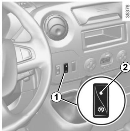
**Besonderer Hinweis:** je nach Fahrzeug wird in manchen dieser Fälle der automatische Neustart des Motors unterdrückt, wenn eine der Türen offen ist.
