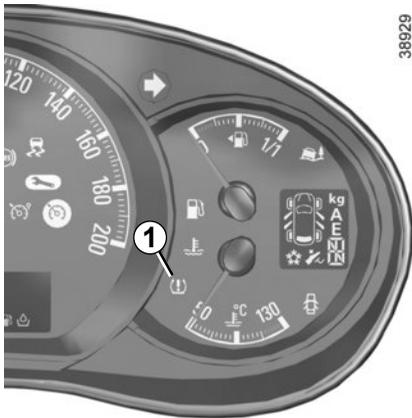
Wenn das Fahrzeug damit ausgestattet ist, gibt dieses System bei Druckverlust eines oder mehrerer Reifen eine Warnung aus.
