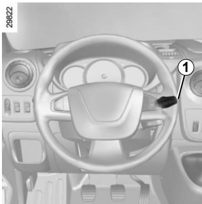
Halten Sie die untere Taste gedrückt, um den Einstellmodus für die Stunden aufzurufen. Wenn diese alleine blinken, drücken Sie auf die obere Taste, um sie vorwärts laufen zu lassen.
