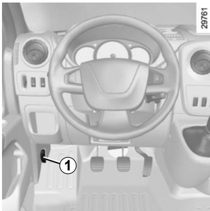
Zum Öffnen am Hebel **1** ziehen.
