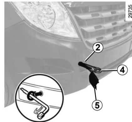
Ziehen Sie die Abschleppöse 4 so fest wie möglich an: Drehen Sie sie zuerst von Hand bis zum Anschlag ein und anschließend mit dem in der Werkzeugbox 3 verstaute Radschlüssel nachziehen
