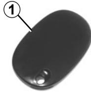
Bei Fahrzeugen, die mit dem Sender-Empfänger **1** ausgestattet sind, ermöglicht diese zusätzlich zu den Funktionen der Fernbedienung, das automatische Ver- und Entriegeln ohne Betätigen der Fernbedienung, sobald diese in einem der Empfangsbereiche **2** ist.
