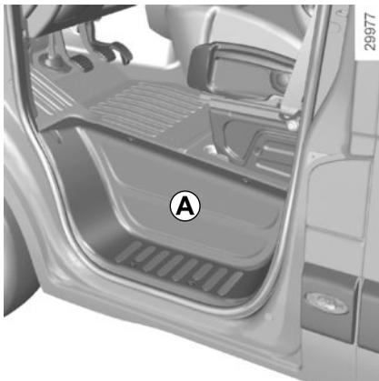
Sie befindet sich hinter der Trittstufe **A** und ist wartungsfrei. **Bitte nicht öffnen und keine Flüssigkeit nachfüllen.**
