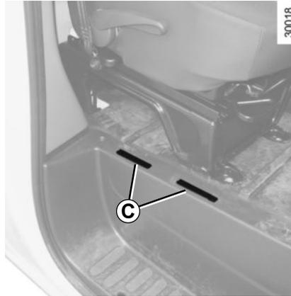
Um an die Fahrzeug-Ident-Nummer und die Seriennummer zu gelangen, rasten Sie die Abdeckungen **C** mit Hilfe eines Schlitzschraubendrehers o. Ä. aus.
