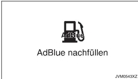
Diese Warnung erscheint, wenn der Füllstand im AdBlue®-Behälter niedrig wird. Die Meldung wird bei jedem Motorstart angezeigt, wenn die geschätzte Fahrstrecke vor dem Leerstand des AdBlue®-Behälters zwischen 2400 und 1000 km (1491 und 621 Meilen) beträgt. Die Meldung kann bis zum nächsten Motorstart ausgeblendet werden.
