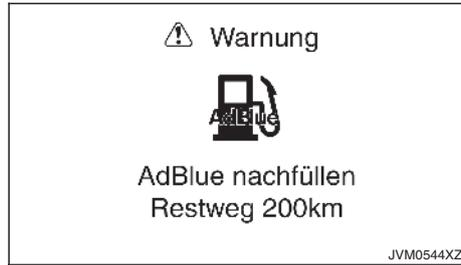
Diese Warnung zeigt die geschätzte Fahrstrecke (0 bis 1000 km (0 bis 621 Meilen)) an, die vor dem Leerstand des AdBlue®-Behälters noch zurückgelegt werden kann. Diese Meldung wird dauerhaft angezeigt und kann nicht ausgeblendet werden.
