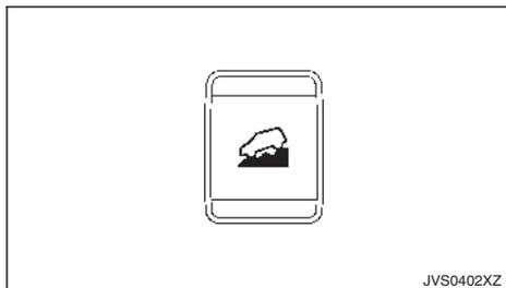
Wenn zusätzliche Bremswirkung an starken Gefällen erforderlich ist, betätigen Sie den Schalter für die Bergabfahrlhilfe, um das System zu aktivieren.
