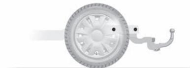
Abschleppvorrichtungen dürfen keine Beleuchtungskomponenten oder das Nummernschild verdecken, wenn sie nicht verwendet werden. Mechanische Abschleppvorrichtungen (Kugel, Haken usw.), die ohne Werkzeug entfernt werden können oder einziehbar sind, müssen entfernt oder neu positioniert werden, wenn sie nicht verwendet werden.
