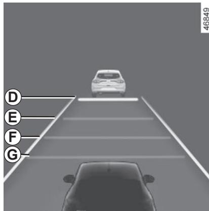
Die horizontalen Abstandsmarkierungen in der Instrumententafel zeigen die verfügbaren Sicherheitsabstände an:
