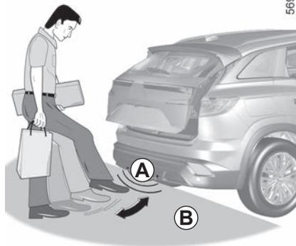
Der Sensor erkennt die Annäherung und Entfernung Ihres Fußes und löst das Öffnen oder Schließen der Heckklappe aus.
