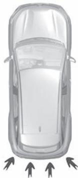
Zusätzlich zur Funktion „Parkdistanzkontrolle“ ➔ 2.144 und anhand der Informationen der vier zentralen Sensoren, die sich am Heck des Fahrzeugs befinden, erkennt das System feste Hindernisse, die sich hinter Ihrem Fahrzeug befinden. Wenn eine erhebliche Kollisionsgefahr besteht, veranlasst das System automatisch eine Bremsung des Fahrzeugs.
