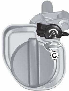
Je nach Fahrzeug ist es notwendig, den Ölmesstab zu arretieren: Drücken Sie den Messstab bis zum Anschlag und drehen Sie ihn dann, um ihn zu arretieren (Bewegung **C**).
