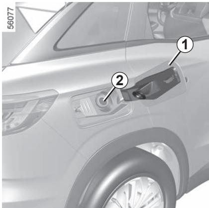
**Unbedingt** bleifreien Kraftstoff verwenden. Die Oktanzahl (RON) muss den Angaben auf dem Aufkleber auf der Tankverschlussklappe **1** entsprechen ➔ 6.6.
