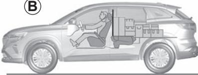
Je nach Fahrzeug ist die Verwendung sinnvoll, um den Gepäckraum vom Fahrgastraum abzutrennen (Transport von Tieren oder Gepäckstücken).
