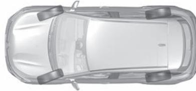
Bei einer höheren Geschwindigkeit bewegen sich die Hinterräder in die gleiche Richtung wie die Vorderräder (Abbildung **B**), um die Straßenlage des Fahrzeugs zu optimieren. Dies ist nützlich bei Spurwechseln, bei Kurvenfahrten ...
