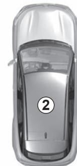
Wenn sich **bei laufendem Motor** nach dem Öffnen und Schließen einer Tür die Keycard nicht mehr im Bereich **2** befindet, erscheint die Meldung „Chipkarte nicht gefunden“, um Sie darauf hinzuweisen, dass sich die Keycard nicht mehr im Fahrzeug befindet. Dadurch kann zum Beispiel ein Wegfahren nach dem Absetzen eines Fahrgasts, welcher die Karte bei sich trägt, verhindert werden.
