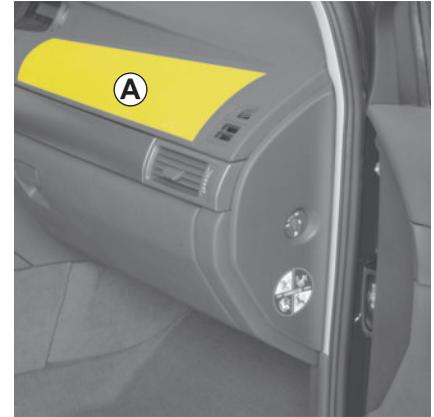
Das Airbag-System funktioniert nach einem pyrotechnischen Prinzip, weshalb es bei der Entfaltung des Airbags zu einer Hitze- und Rauchentwicklung kommt (was nicht den Beginn eines Brandes anzeigt) und ein Knall zu hören ist. Die notwendigerweise sehr schnelle Entfaltung des Airbags kann Verletzungen auf der Hautoberfläche oder andere Unannehmlichkeiten verursachen.
