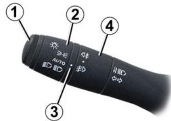
Mit dem mittleren Ring **4** des Hebels drehen Sie das Symbol zur Markierung **3** und lassen ihn dann los.
