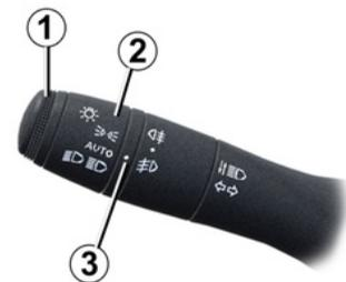
Drehen Sie bei eingeschalteter Zündung den Ring **2** am Bedienhebel **1**, bis das Symbol AUTO der Markierung **3** gegenüberliegt. Die Warn-
