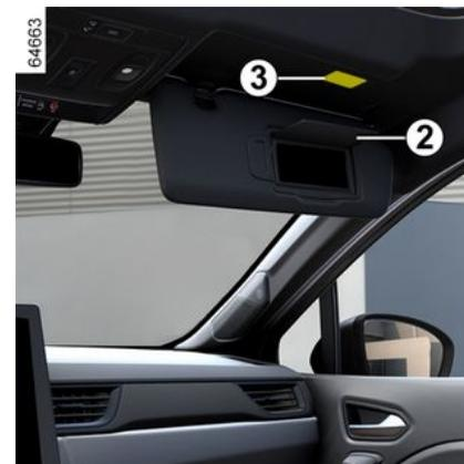
Abdeckung **2** anheben. Die Beleuchtung **3** ist automatisch.
