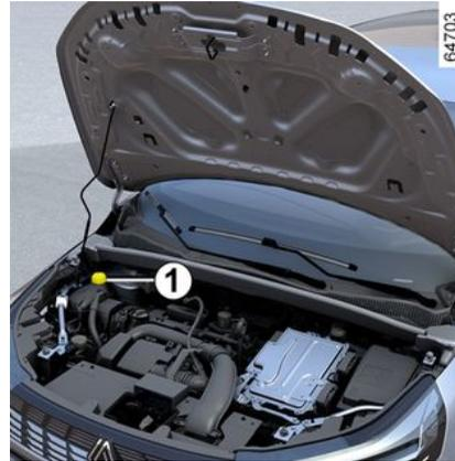
Bei ausgeschalteter Zündung und mit dem Fahrzeug auf ebener Fläche stehend muss der Füllstand in **kaltem Zustand** zwischen den Markierungen „MINI“ und „MAXI“ im Kühflüssigkeitsbehälter **1** liegen.
