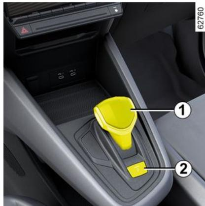
Bei stehendem Fahrzeug, laufendem Motor oder eingeschalteter Zündung drücken Sie auf die Taste **2**, um die Position **P** einzulegen. Die Warnlampe des Schalters **2** leuchtet
