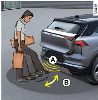
Die Funktion „Keyless Entry & Drive“ ermöglicht den Zugang zum Gepäckraum, wenn Sie keine Hand frei haben. Achten Sie darauf, dass sich die Karte im hinteren Bereich des Fahrzeugs befindet (Bereich **B**). Stellen Sie sich etwa 45 Zentimeter hinter den Heckstoßfänger und bewegen Sie den Fuß innerhalb des Bereichs **A** vor und zurück.
