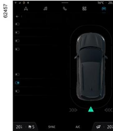
Zum Aktivieren oder Deaktivieren der Funktion wählen Sie in der Umgebung „Fahrzeug“ die Option „Einparkhilfen“ aus. Wählen Sie „Aktive Notbremsung im Rückwärtsgang“.
