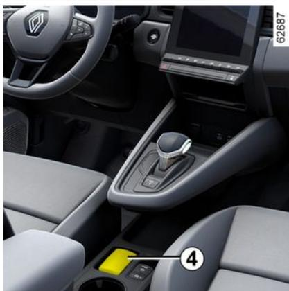
Betätigen Sie das Bremspedal, und setzen Sie die Keycard **4** (Knopfseite) in den Platzierungsbereich **3**. Drü-
