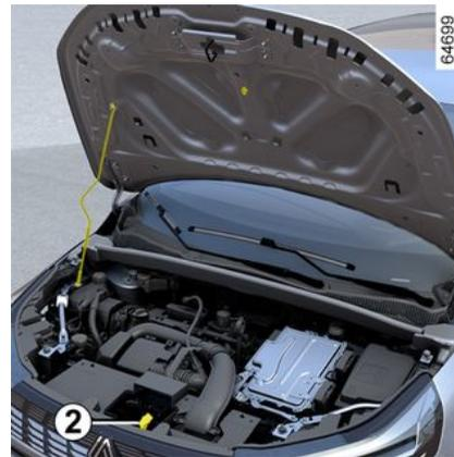
Zum Entriegeln die Lasche **2** drücken, während die Motorhaube geöffnet wird.
