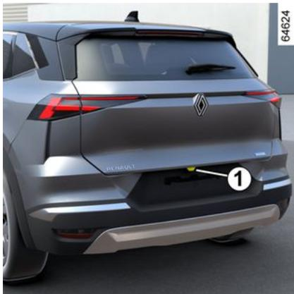
Wenn der Rückwärtsgang eingelegt wird, überträgt die Kamera **1** am Heck des Fahrzeugs auf dem Multimedia-Display **2** einen Blick auf den Bereich hinter dem Fahrzeug, begleitet von einer bis drei Maßlinien **3, 4** oder **5** (fest, beweglich und Anhänger-Orientierungslinien).
