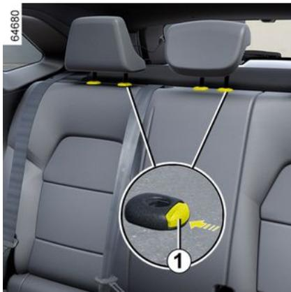
Schieben Sie die Kopfstütze bis zum Anschlag nach oben, drücken Sie auf die Taste **1** und ziehen Sie die Kopfstütze heraus.
