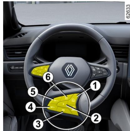
Durch Drücken des Schalters **2** (0) wird die Funktion des Geschwindigkeitsbegrenzers ausgesetzt. Die Grenzgeschwindigkeit wird gespeichert und in grauer Schrift auf der Instrumententafel angezeigt.
