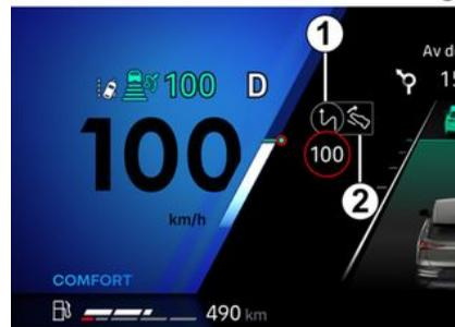
Bei Annäherung an eine bestimmte Fahrsituation werden die Kontrolllampen 1 und 2 auf der Instrumententafel angezeigt.
