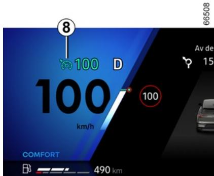
Bei gespeicherter Geschwindigkeit wird die Aktivierung der Geschwindigkeitsregelung durch Anzeige der Regelgeschwindigkeit in grün und, abhängig vom Fahrzeug, die Anzeige der Warnlampe **8** bestätigt.
