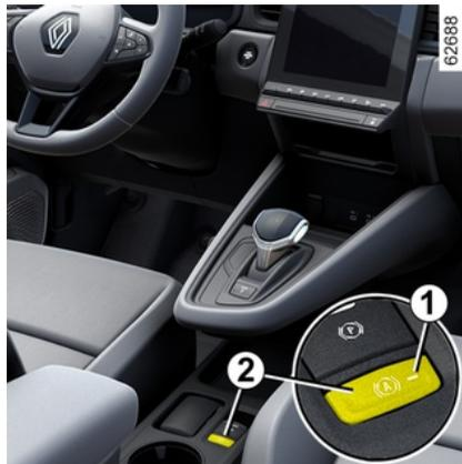
Betätigen Sie das Bremspedal und den Schalter **2** gleichzeitig.
