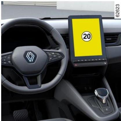
Über das Menü MULTI-SENSE auf dem Multimedia-Display **20** oder durch Drücken des Schalters **19** kann der Modus ECO aktiviert werden, der Einfluss auf die Temperatur hat und den Kraftstoffverbrauch des Fahrzeugs reduziert.
