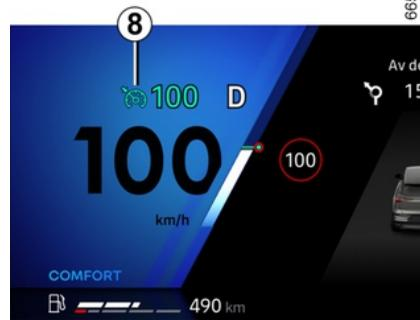
Die **8** Kontrolllampe verschwindet von der Instrumententafel, um zu bestätigen, dass die Funktion deaktiviert ist.
