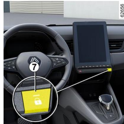
Der Schalter **7** steuert gleichzeitig die Türen, die Gepäckraumklappe und die Kraftstofftankklappe.
