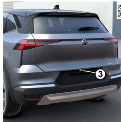
Die Ansicht der rückwärtigen Kamera wird auf dem Multimedia-Display **5** angezeigt.
