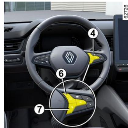
Bei damit ausgestatteten Fahrzeugen können Sie die Bedienelemente für Freisprecheinrichtung 6 und Spracherkennung 7 benutzen.
