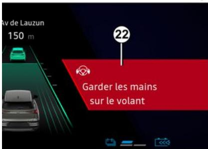
Wenn die „Spurhaltefunktion“ keine Hände am Lenkrad erkennt, wird eine mehrstufige Warnung ausgelöst:
