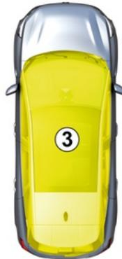
Wenn sich die Karte nach dem Öffnen und Schließen einer Tür **bei laufendem Motor** nicht mehr in der Zone **3** befindet, warnt Sie die Meldung „Karte nicht erkannt“, dass sich die Karte nicht mehr im Fahrzeug befindet. Dadurch kann zum Beispiel ein Wegfahren nach dem Absetzen eines Fahrgasts, welcher die Keycard bei sich trägt, verhindert werden.
