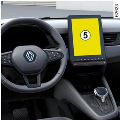
Über das Multimedia-Display können Sie, wenn das „360°-Kamera“-System angezeigt wird, die Ansichten ändern (z. B. Vogelperspektive durch Rückansicht ersetzen).
