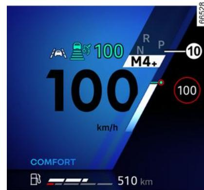
**Hinweis:** Um in den Automatikmodus zurückzukehren, halten Sie (je nach Fahrzeug) die rechte Schaltwippe gedrückt oder bewegen Sie den Impulshebel **1** eine oder zwei Kerben nach hinten.
