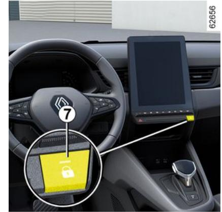
Nach dem Starten des Fahrzeugs verriegelt das System die Türen automatisch, sobald eine Geschwindigkeit von ca. 10 km/h erreicht wird.
