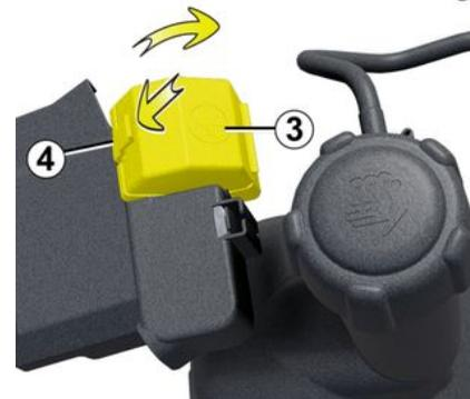
**Hinweis:** Öffnen Sie die Abdeckung **3** der Klemme **1 (+)**, indem Sie die Taste **4** in Pfeilrichtung drücken.
