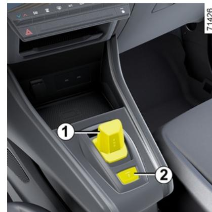
Schalten Sie den Wahlhebel **1** eine oder zwei Stufen nach vorne oder nach hinten, um die gewünschte Position (**R, N, D**) zu wählen und lassen Sie den Wahlhebel dann los. Dieser kehrt dann in seine stabile Position zurück.
