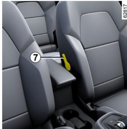
Schieben Sie den Hebel **7** nach unten, um die Stützfunktion zu verstärken, oder nach oben, um sie abzuschwächen.
