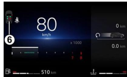
Wenn bei geschlossenen Türen die Zündung eingeschaltet wird, erscheint etwa 60 Sekunden lang die Grafik **6** an der Instrumententafel. Dies informiert den Fahrer jedes Mal über den Anlegestatus der einzelnen vorderen Sicherheitsgurte:
