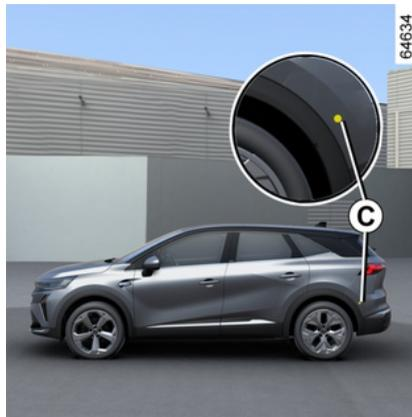
Die Funktion nutzt die Informationen der Sensoren auf jeder Seite des hinteren Stoßfängers (Bereich **C**), um den Fahrer zu warnen:
