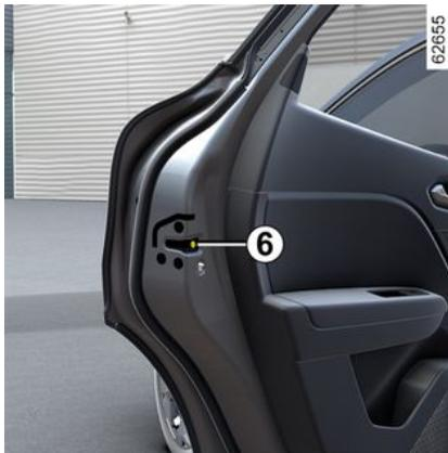
Drehen Sie bei geöffneter Tür die Schraube **6** (mit dem Ende des Schlüssels) und schließen Sie die Tür. Sie ist nun von außen verriegelt. Das Öffnen kann nun nur von innen erfolgen oder mit dem Schlüssel für die Fahrertür.
