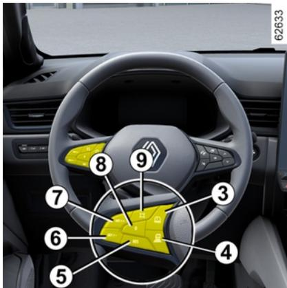
Die Funktion des „adaptiven Tempomaten“ wird unterbrochen, sobald Sie den Schalter **3** betätigen.
