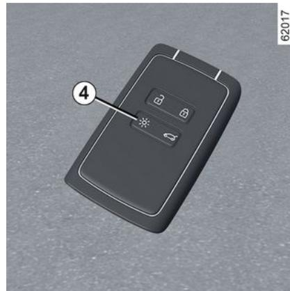
Drücken Sie die Taste 4, um das Abblendlicht und die Außenbeleuchtung für etwa 20 Sekunden einzuschalten. Dies ermöglicht es beispielsweise, das Fahrzeug in einem Parkhaus zu orten.
