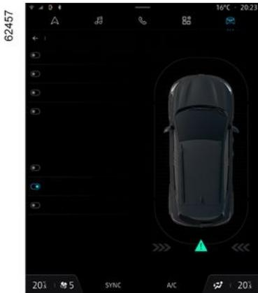
Wählen Sie ausgehend vom Multimedia-Display **1** das Menü „Fahrzeug“, dann „Parkassistent“ oder deaktivieren Sie die Funktion. Wählen Sie „Aktive Notbremsung hinten“.
