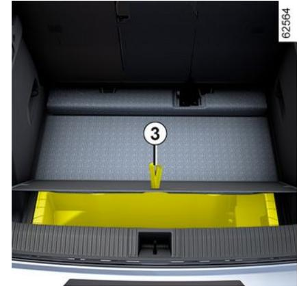
Dieses Ablagefach ist für Ladekabel vorgesehen. Die maximal zulässige Last für das Ablagefach beträgt 15 kg. Um darauf zuzugreifen, öffnen Sie den Gepäckraum und heben dann die Gepäckraummatte mit dem Griff **3** an.
