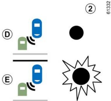
Erste Warnung: **Blinker nicht betätigt**. Die Kontrolllampe **2** zeigt an, dass ein Fahrzeug im toten Winkel erfasst wurde und/oder dass sich ein Fahrzeug in einer benachbarten Spur schnell von hinten nähert.
