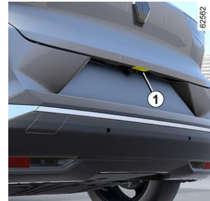
Drücken Sie die Taste **1** und heben Sie die Gepäckraumklappe an.
