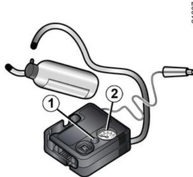
Verwenden Sie bei einer Reifenpanne das im Gepäckraum befindliche Reifenfüllset.
