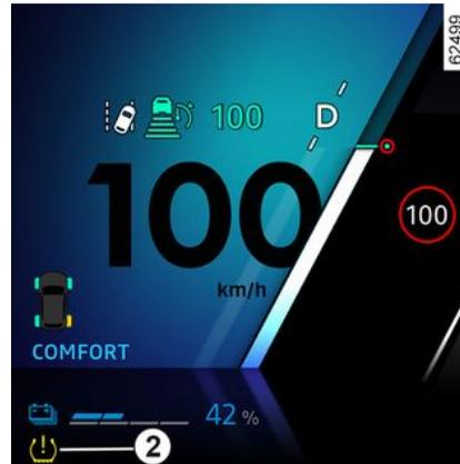
Dieses System erkennt einen Reifendruckverlust der Reifen, indem die Geschwindigkeit der Räder während der Fahrt gemessen wird.
