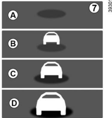
Wenn die Funktion aktiviert ist, wird die Anzeige **B** in der Instrumententafel angezeigt und informiert den Fahrer über den Abstand zwischen seinem und dem vorausfahrenden Fahrzeug.
