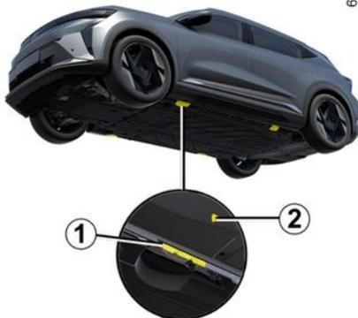
Ihr Fahrzeug ist mit vier dafür vorgesehenen Hebepunkten **1** ausgestattet, die sich unter dem Fahrzeug befinden.
