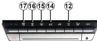
Die Taste **15** drücken und die integrierte Warnleuchte schaltet sich ein. Diese Funktion ermöglicht es, die Heckscheibe und die Außenspiegel entsprechend ausgestatteter Fahrzeuge schnell von Beschlag und Vereisung zu befreien.
