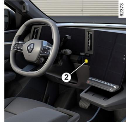
Wenn sich das Smartphone nicht mehr im Fahrgastraum befindet, wenn Sie versuchen, den Motor auszuschalten, wird eine Meldung auf der Instrumententafel angezeigt: Halten Sie die Start/Stop-Taste des Motors **2** länger als zwei Sekunden gedrückt.
