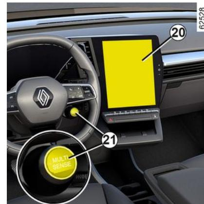
Über das Menü MULTI-SENSE auf dem Multimedia-Bildschirm **20** oder durch Drücken des Schalters **21** kann der Modus ECO aktiviert werden, der Einfluss auf die Temperatur hat und den Kraftstoffverbrauch des Fahrzeugs reduziert.
