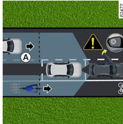
Diese Funktion ist eine zusätzliche Fahrhilfe für die Sicherheit der Insassen des Fahrzeugs.
