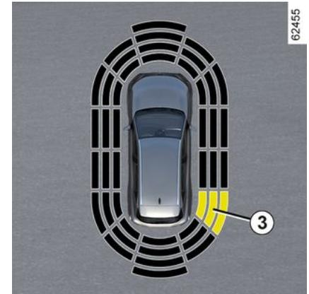
Je nach Ausrichtung der Räder bestimmt das System die Fahrtrichtung
