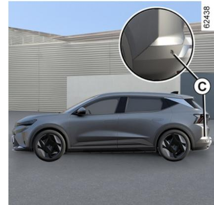
Achten Sie darauf, dass der Bereich **C** um die Radare auf beiden Seiten des hinteren Stoßfängers nicht (durch Schmutz, Schlamm, Schnee usw.) behindert ist.
