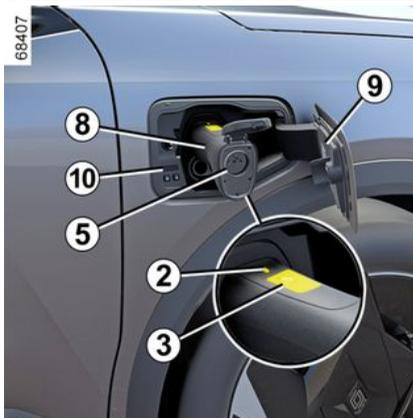
– Drücken Sie gegen die Ladeklappe **9**, um diese zu entriegeln.
