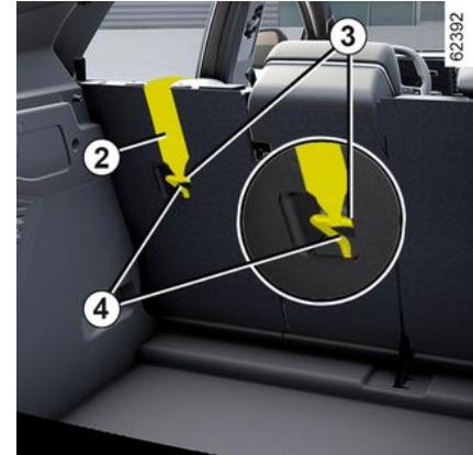
Der dritte Ring **4** wird zur Befestigung des oberen Gurtes an einigen Kindersitzen verwendet. **2** bei einigen Kindersitzen.
