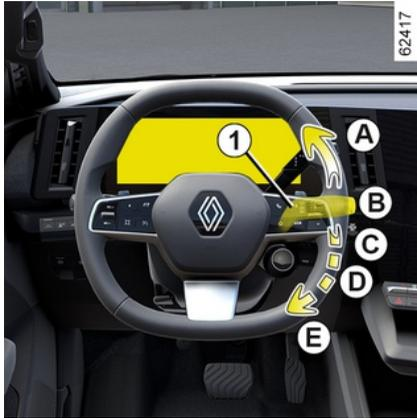
Bei eingeschalteter Zündung am Hebel **1** ziehen und wieder loslassen.
