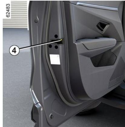
Drehen Sie bei geöffneter Tür die Schraube **4** (mit dem Ende des Schlüssels) und schließen Sie die Tür. Sie ist nun von außen verriegelt. Die Fahrtür kann nun nur von innen oder mit dem Notschlüssel geöffnet werden.
