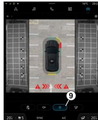
Drücken Sie auf dem Multimedia-Bildschirm die spezielle Schaltfläche 9, um eine kombinierte Ansicht aus einer
