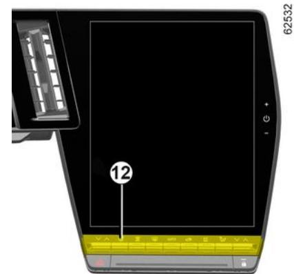
Um den Luftstrom der Lüftungsschlitze **1** und **3** zu steuern, drücken oder heben Sie den Regler **12** auf das gewünschte Niveau.
