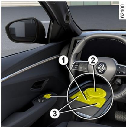
Wählen Sie den Rückspiegel mit einem der Schalter **3** und stellen Sie ihn dann mit dem Schalter **2** in die gewünschte Position.
