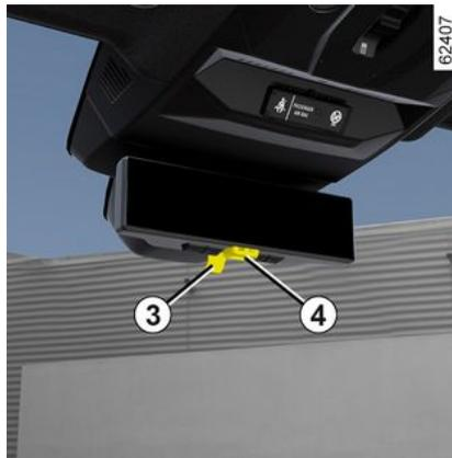
Verwenden Sie den Hebel **3**, um zwischen „Spiegel“- und „Bildschirm“-Modus zu wechseln.
