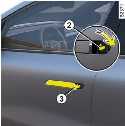
Bewegen Sie die Schlossabdeckung **3** durch Drücken des linken Teils und stecken Sie den Schlüssel **2** in das Schloss, um die Fahrtür zu ver- oder entriegeln.
