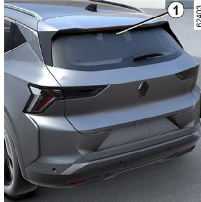
Je nach Fahrzeugausführung wird die Rückansicht durch die Kamera 1 angezeigt.
