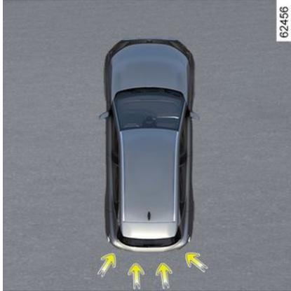
Als Ergänzung zu der Funktion „Parkassistent“ → 288 und anhand der Informationen der vier zentralen Sensoren, die sich am Heck des Fahrzeugs befinden, erkennt das System feste Hindernisse, die sich hinter dem Fahrzeug befinden. Wenn eine erhebliche Kollisionsgefahr besteht, veranlasst das System automatisch eine Bremsung des Fahrzeugs.
