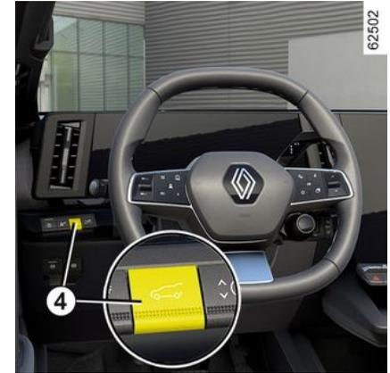
Zum Öffnen der Heckklappe halten Sie den Schalter 4 gedrückt, bis das akustische Signal ertönt und lassen dann den Schalter sofort los.
