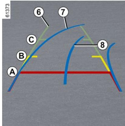
Die auf den Multimediabildschirm **5** übertragene „Vorder-“ oder „Rückansicht“ wird mit einer, zwei oder drei Maßlinien **6**, **7** und **8** dargestellt.
