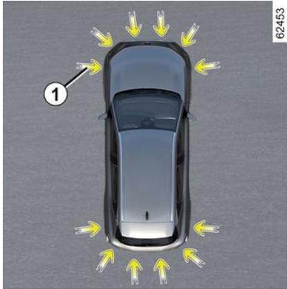
Die durch die Pfeile **1** gekennzeichneten Ultraschallsensoren an den Stoßfängern, dienen zur Erkennung von Hindernissen in der Fahrzeugumgebung.
