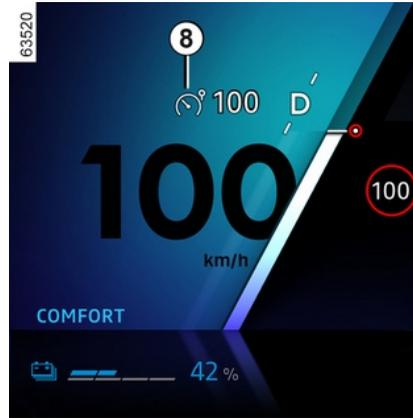
Die Geschwindigkeitsbegrenzerfunktion wird unterbrochen, wenn Sie den Schalter **1** drücken, um den Begrenzer abzuwählen. In diesem Fall ist keine Geschwindigkeit mehr gespeichert.
