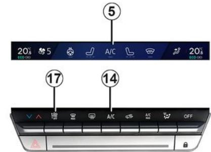
Das System steuert die Gebläseleistung, die Luftverteilung, den Umluftbetrieb, das Ein- und Ausschalten der Klimaanlage und die Lufttemperatur.
