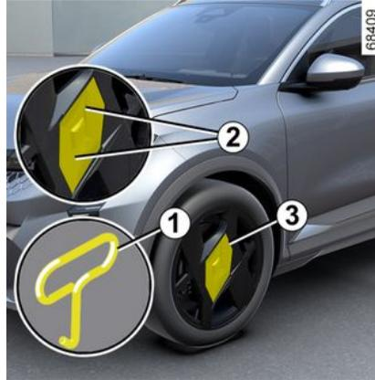
Diese mittels Radkappenwerkzeug **1** (im Bordwerkzeug) entfernen, indem der Haken in eine der Kerben **2** der Radnabenkappe **3** eingeführt wird. Ziehen Sie am Radkappenwerkzeug, bis eines der Befestigungselemente vollständig entfernt ist. Wiederholen Sie den Vorgang an der anderen Kerbe **2**. Ziehen Sie mit den Händen an den Enden der Radnabenkappe, bis sie vollständig entfernt ist.
