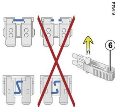
Entfernen Sie die Sicherung mit der Klemme **6**, die sich auf der Sicherungsplatte befindet.
