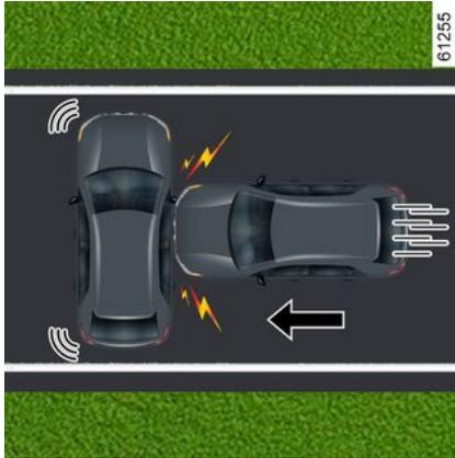
**Seitenkollision mit einem anderen Fahrzeug einer gleichwertigen oder höheren Kategorie mit einer Kollisionsgeschwindigkeit von mindestens 50 km/h**
