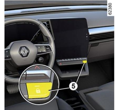
Der Schalter **5** steuert gleichzeitig die Türen und die Gepäckraumklappe.
