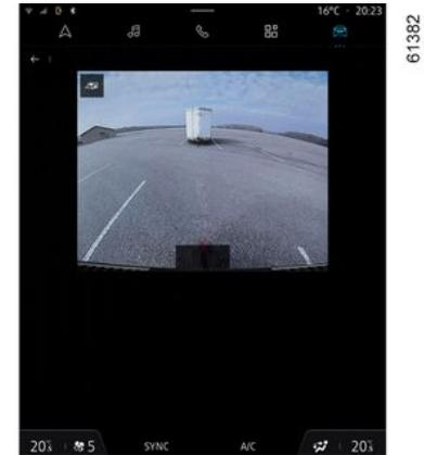
Drücken Sie im Vorwärtsgang, wenn ein Anhänger angeschlossen ist, das Menü „360° Kamera“ in der Welt „Fahrzeug“ auf dem Multimedia-Display **5**, um die Kamera **3** zu aktivieren und für ca. 30 Sekunden eine Ansicht der Umgebung zu übertragen.
