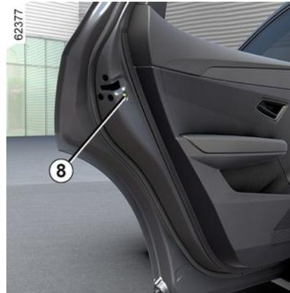
Um zu verhindern, dass die hinteren Türen von innen geöffnet werden können, senken Sie den Hebel **8** und
