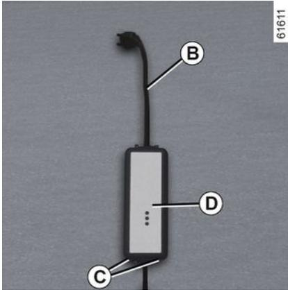
**i** Wenn während des Ladevorgangs eine Störung auftritt (Aufleuchten der roten Kontrolllampe **D**), müssen Sie den Ladevorgang sofort unterbrechen. Siehe dazu die Bedienungsanleitung des Ladekabels.
