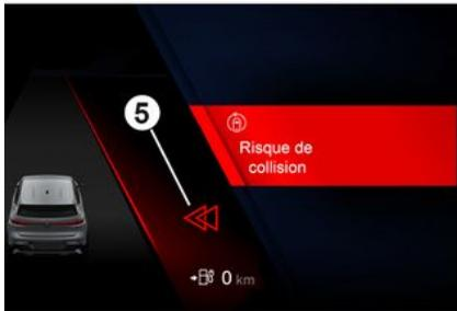
Wenn beim Fahren mit einer Geschwindigkeit zwischen ca. 65 km/h und 110 km/h die Gefahr eines Zusam-
