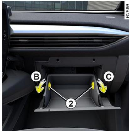
Drehen Sie die Anschläge **2** nach dem Öffnen um eine Vierteldrehung (Bewegungen **B** und **C**), um sie zu entfernen.
