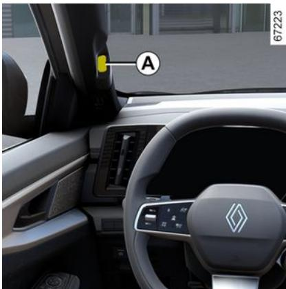
Nach dem Speichern Ihres Profils im Multimediasystem ist es möglich, die Benutzereinstellungen des Fahrers (Fahrersitzposition usw.) beim Einsteigen in das Fahrzeug mit der Kamera **A** abzurufen.
