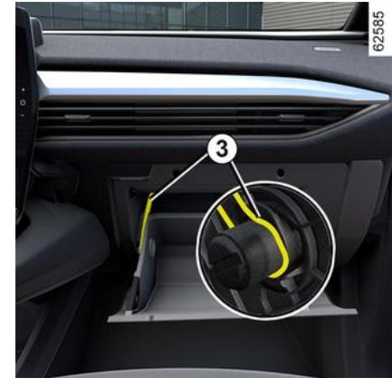
Haken Sie das Kabel **3** aus, um das Handschuhfach zu lösen und Zugang zum Sicherungskasten zu erhalten.
