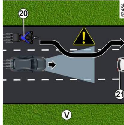
Falls Ihr Fahrzeug von einem anderen, mit hoher Geschwindigkeit fahrenden Fahrzeug **20** (Motorrad, Pkw usw.) überholt wird und sich dieses Fahrzeug vorübergehend zwischen Ihnen und dem vorausfahrenden Fahrzeug befindet **21**, kann das System eine **übermäßige Beschleunigung, Verlangsamung oder Bremsung auslösen**.
