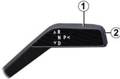
Bei stehendem Fahrzeug, laufendem Motor oder eingeschalteter Zündung drücken Sie auf die Taste **2**, um die Position P einzulegen.
