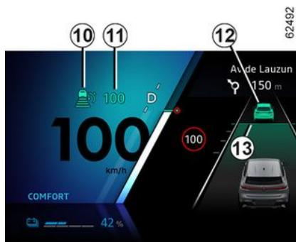
**10.** Kontrolllampe für den adaptiven Tempomaten mit Stop and Go-Funktion
