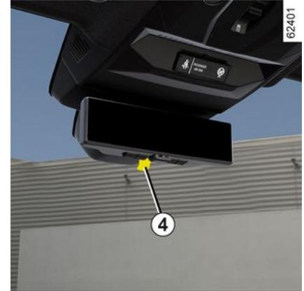
Um beim Fahren in Dunkelheit nicht von den Scheinwerfern des nachfolgenden Fahrzeugs geblendet zu werden, betätigen Sie den kleinen Hebel **4** hinter dem Rückspiegel.
