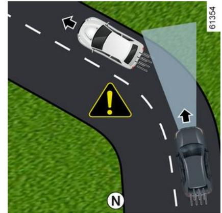
Wenn Sie in eine Kurve einfahren, erkennt das Radar bzw. die Kamera das vorausfahrende Fahrzeug möglicherweise vorübergehend nicht (siehe **N**).
