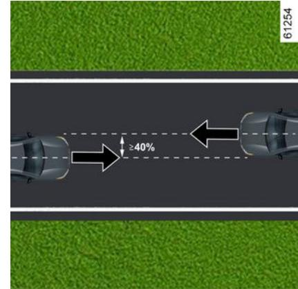
**Frontalkollision mit einem anderen Fahrzeug einer gleichwertigen oder höheren Kategorie mit einer Kollisionsfläche von mindestens 40 %, wobei die Geschwindigkeit beider Fahrzeuge mindestens 40 km/h beträgt.**
