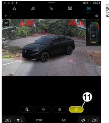
Auf dem Multimediabildschirm erhalten Sie durch Drücken der speziellen Taste **11** eine 3D-Ansicht, die es Ihnen ermöglicht, das Fahrzeug und seine Umgebung dreidimensional zu betrachten.
