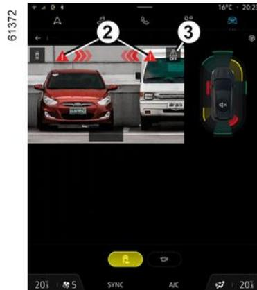
Wenn das Fahrzeug mit einer vom System erkannten Anhängerzugvorrichtung ausgestattet ist und ein Anhänger angeschlossen wurde, wird die aktive Notbremsung im Rückwärtsgang automatisch deaktiviert und die Meldung „Anhänger: Parksensoren nicht verfügbar“ erscheint in der Instrumententafel zusammen mit der Warn-
