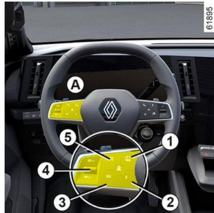
Durch Drücken des Schalters **2** (0) wird die Funktion des Geschwindigkeitsbegrenzers ausgesetzt.
