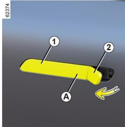
Die Türen vorne und Türen hinten sind mit Türgriffen ausgestattet, die je nach Fahrzeugstatus automatisch ein- oder einklappen:
