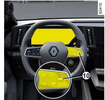
Informationsbereich 7, bewegen Sie sich mittels des Bedienelements 10 durch die verschiedenen Widgets der Instrumententafel A, um eines davon auszuwählen:
