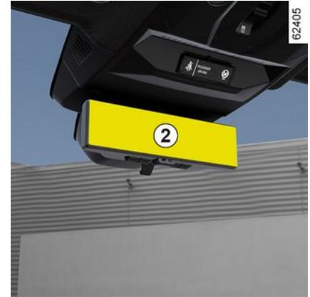
Bei eingeschalteter Zündung zeigt der an der Dachmittelkonsole montierte Rückspiegel 2 die Sicht hinter dem Fahrzeug an, die von der Kamera 1 übertragen wird.
