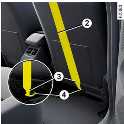
Befestigen Sie den Haken **3** des oberen Riemens **2** an dem Ring **4**, der mit
