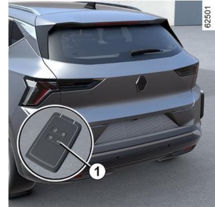
Bei ausgeschaltetem Motor die Taste **1** auf der Keycard gedrückt halten, während diese sich in der Nähe des Gepäckraums befindet.
