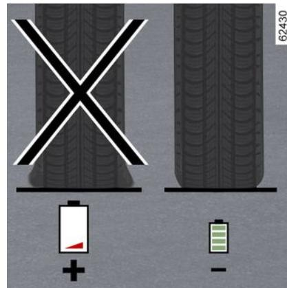
Ein zu niedriger Reifendruck erhöht den Kraftstoffverbrauch. Der für Ihr Fahrzeug vorgeschriebene Reifendruck muss unbedingt eingehalten werden.
