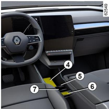
Es kann ein Einsatz **7** verwendet werden, um die Mittelkonsolenablage zu unterteilen (es sind mehrere Optionen möglich, je nach Position des Unterteilers in den Führungsschlitzen **5**).
