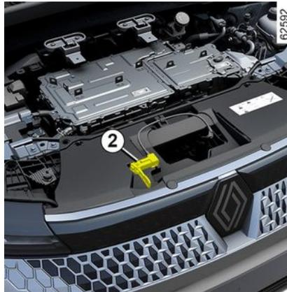
Heben Sie die Motorhaube etwas an und schieben Sie den Hebel **2** nach links.
