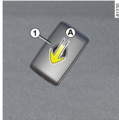
Der integrierte Schlüssel **2** wird zum Ver- oder Entriegeln der linken Vordertür verwendet, wenn die Karte nicht funktioniert.
