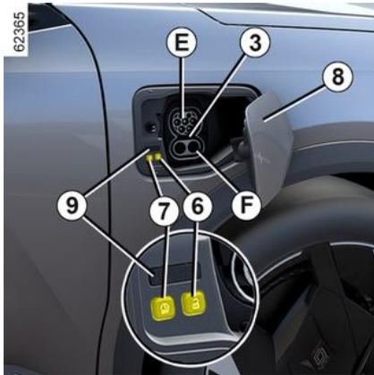
**Hinweis:** bei Schneefall vor dem Anschließen und Abziehen des Ladekabels den Schnee rund um die Steckdose des Fahrzeugs auf der Beifahrerseite entfernen.
