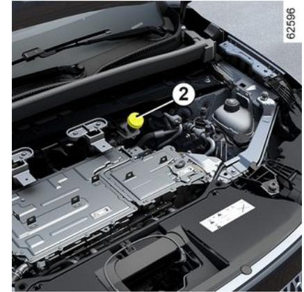
Die Kontrolle des Füllstandes erfolgt bei abgestelltem Motor auf ebener Fläche. Kontrollintervalle: Häufig - in jedem Fall, sobald Sie nur die leichteste Beeinträchtigung der Bremsen feststellen.
