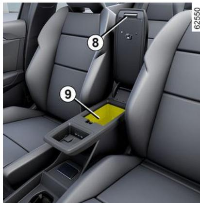
Heben Sie je nach Fahrzeug die Abdeckung der verschiebbaren Armlehne durch Drücken der Taste **8** an.
