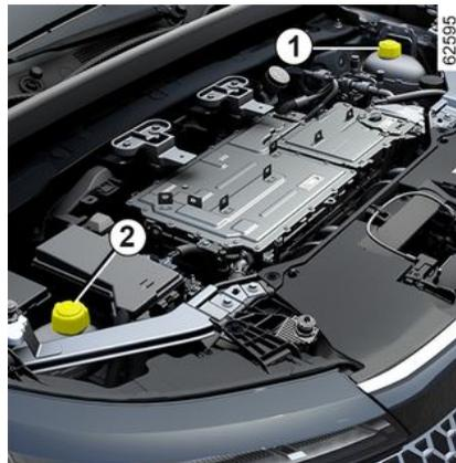
Je nach Fahrzeug kann die Lage der Kühlflüssigkeitsbehälter unterschiedlich sein:
