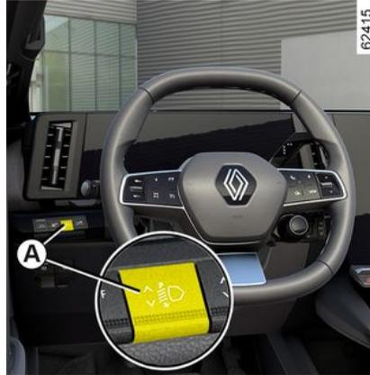
Je nach Fahrzeug kann die Leuchtweitereinstellung mit dem Schalter **A** an die Ladung angepasst werden.
