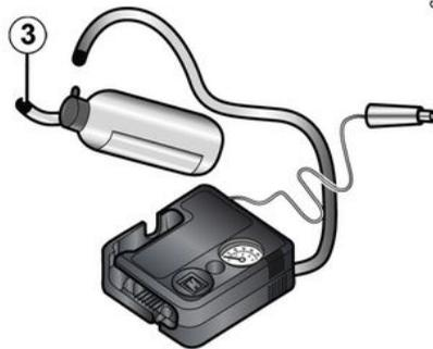
Wenn der Reifen korrekt befüllt ist, nehmen Sie das Füllset ab: Schrauben Sie den Adapter langsam von der Flasche **3**, um zu vermeiden, dass Produkt ausspritzt, und bewahren Sie die Flasche in einer Plastikverpackung
