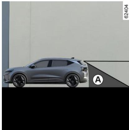
Das Sichtfeld der Kamera deckt nicht den gesamten Bereich hinter dem Fahrzeug ab, insbesondere nicht den Bereich des toten Winkels **A**.
