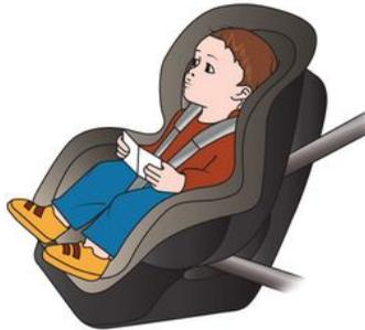
Bis zu 18 kg oder 4 Jahre darf das Kind auf einem nach vorne gerichteten Sitz reisen. Wählen Sie den Sitz entsprechend der Größe des Kindes aus: Kopf und Rumpf sind die Bereiche, die am besten geschützt werden müssen. Ein in Fahrtrichtung montierter Kindersitz, der ordnungsgemäß im Fahrzeug befestigt ist, reduziert das Risiko von Kopfverletzungen. Befördern Sie Ihr Kind in einem in Fahrtrichtung montierten Kindersitz mit Hosenträgergurt, solange dies bezogen auf die Größe des Kindes möglich ist.
