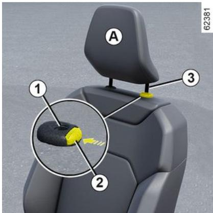
Ziehen Sie die Kopfstütze bis in die gewünschte Position nach oben. Überprüfen Sie die korrekte Verriegelung
