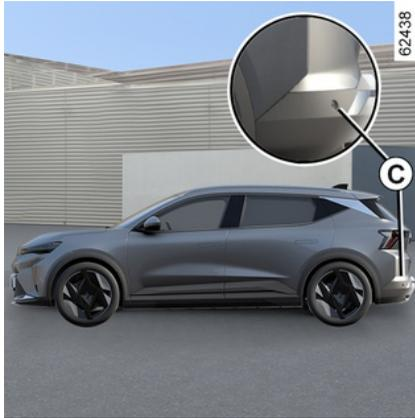
Achten Sie darauf, dass der Bereich **C** um die Radare auf beiden Seiten des hinteren Stoßfängers nicht (durch Schmutz, Schlamm, Schnee usw.) behindert ist.
