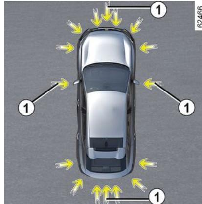
Die durch die Pfeile **11** markierten in den Stoßfängern verbauten Ultraschalldetektoren helfen bei der Suche nach Parklücken und beim Einparken.
