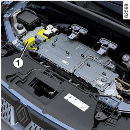
Die Zusatzbatterie ist eine 12-V-Batterie. Sie liefert Energie für den Betrieb der Fahrzeugausrüstung (Scheinwerfer, Scheibenwischer, Fensterheber, Audiosystem usw.) und bestimmter Sicherheitssysteme wie zum Beispiel Bremsunterstützung.
