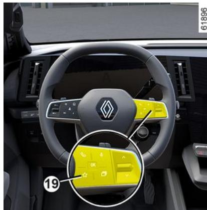
Je nach Fahrzeug können Sie durch Drücken der Lenkradsteuerung **19** folgende Funktionen entsprechend den zuvor gespeicherten Nutzungseinstellungen aktivieren:
