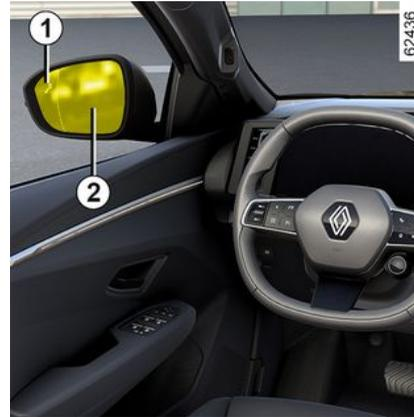
Wenn eine Tür geöffnet wird und ein sich bewegendes Objekt erkannt wird, wird die Warnleuchte **1** im Außenrückspiegel **2** angezeigt und je nach Fahrzeug leuchtet die Umfeldbeleuchtung an der Vordertür auf.
