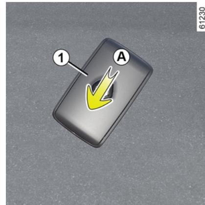
Erscheint die Meldung „Batterie Karte fast leer“ auf der Instrumententafel angezeigt, tauschen Sie die Keycard-Batterie aus:
