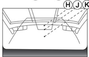
Position **H** scheint auf dem Bildschirm weiter entfernt zu sein als Position **J**. Allerdings befindet sich Position **H** in der gleichen Entfernung wie Position **K**.
