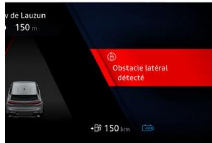
Beim Fahren zwischen ca.65 km/h und 180 km/h: wenn Sie sich einer (durchgehenden oder unterbrochenen) Linie nähern und die Gefahr eines Zusammenstoßes mit einem Fahrzeug besteht, das sich im toten Winkel **D** befindet und sich in die gleiche Richtung wie Ihr Fahrzeug bewegt, oder mit einem Fahrzeug, das sich auf einer angrenzenden Fahrspur schnell von hinten nähert und sich im Erfassungsbereich **E** befindet, wird das System aktiviert:
