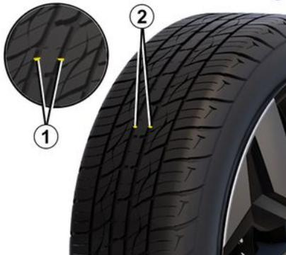
Die Reifen müssen in gutem Zustand sein und das Profil ausreichend Tiefe aufweisen; Reifen, die die technische Abteilung genehmigt hat, verfügen über Warnstreifen **1**; das sind **an mehreren Stellen in die Lauffläche eingebaute Indikatoren**.
