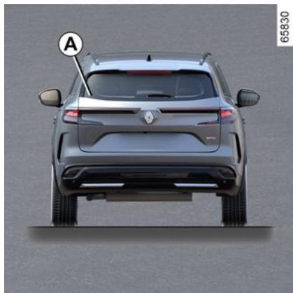
Der QR Code auf Aufkleber **A** ermöglicht es Notfallassistenten mithilfe eines Tablets oder Smartphones, sofort auf die technische Information zuzugreifen, die für Arbeiten am Fahrzeug bei einem Notfall erforderlich sind.
