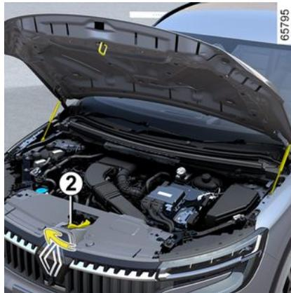
Zum Entriegeln den Hebel **2** beim Öffnen der Motorhaube nach links drücken.
