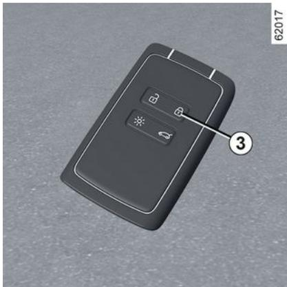
Wenn sich die Karte etwa 15 Minuten lang im Erfassungsbereich **1** befunden hat, wird die Fernverriegelung deaktiviert. Das Fahrzeug durch Drücken der Taste **3** an der Karte verriegeln.
