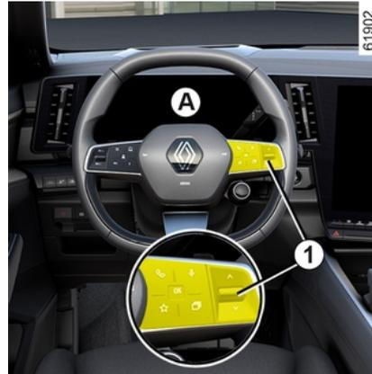
Halten Sie nach Auswahl des gewünschten Fahrparameters der Schalter **1** solange gedrückt, bis der Wert auf Null zurückspringt.
