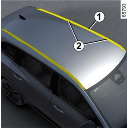
Die Halterungen **2** befinden sich an den Dachlängsträgern **1**.
