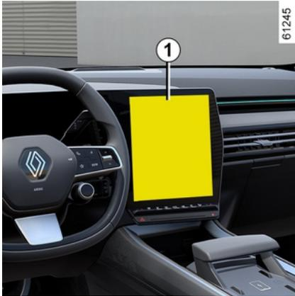
Uhrzeit und Außentemperatur werden im Multimedia-Display **1** angezeigt.
