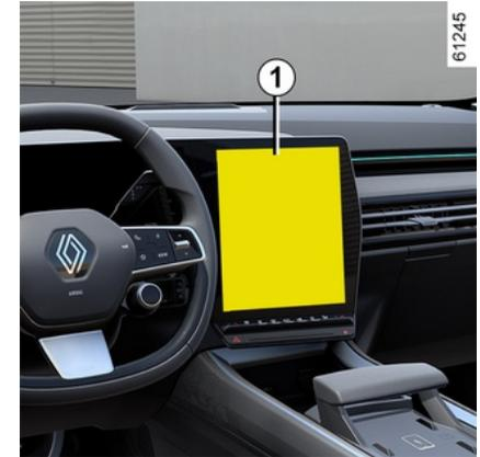
Drücken Sie bei stehendem Fahrzeug und eingeschaltetem Motor in der Welt „Fahrzeug“ **2** auf dem Multimedia-Bildschirm **1** auf das Menü „Elektro“ **3** und dann auf die Registerkarte „Laden & Klimaanlage“, um auf die Einstellungen zuzugreifen.
