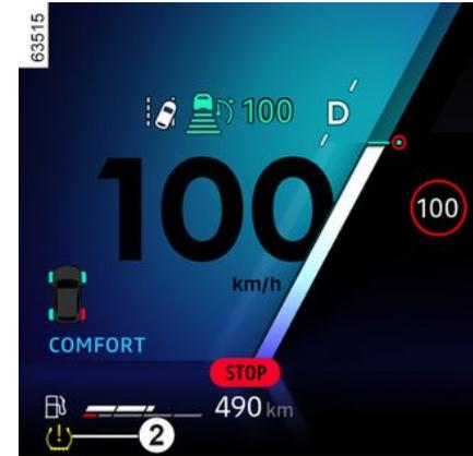
Dieses System erkennt einen Reifendruckverlust der Reifen, indem die Geschwindigkeit der Räder während der Fahrt gemessen wird.
