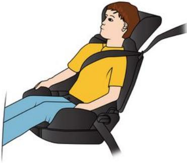
Ab einem Gewicht von 15 kg oder dem Alter von 4 Jahren kann ein Kind auf einer Sitzerhöhung Platz nehmen, die eine Anpassung des Sicherheitsgurts an den Körper des Kindes ermöglicht. Das Sitzkissen der Sitzerhöhung muss Beckengurtführungen aufweisen, damit der Sicherheitsgurt auf den Oberschenkeln und nicht am Bauch des Kindes verläuft. Damit der Gurt über die Mitte der Schulter verläuft, empfehlen wir die Verwendung einer Sitzerhöhung mit verstellbarer Rückenlehne
