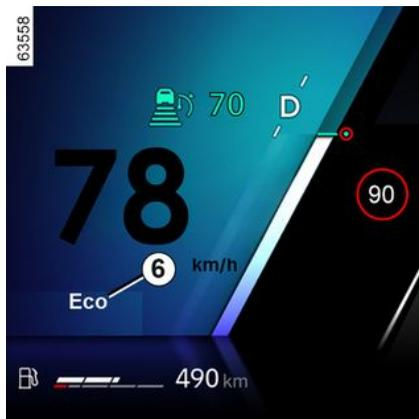
Die Kontrolllampe „ECO“ 6 wird in der Instrumententafel angezeigt, um die Aktivierung zu bestätigen.
