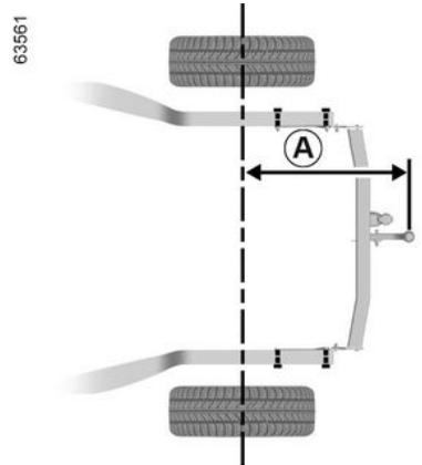
Maximale Abmessung **A**: 1,184 mm
