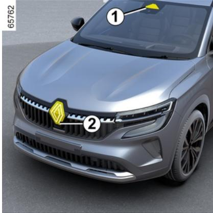
Diese Funktion nutzt Informationen von Radar **2** und Kamera **1** und informiert den Fahrer über den zeitlichen Abstand zwischen dem eigenen und dem vorausfahrenden Fahrzeug, so dass ein sicherer Abstand zwischen beiden Fahrzeugen gehalten werden kann.
