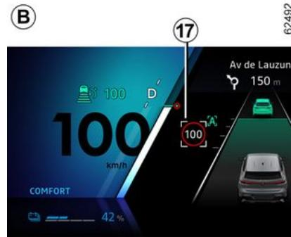
Anhand der Kamera, der Funktion „Verkehrszeichenerkennung“ → 218 und der mit dem Abonnement verbundenen Karte nimmt das System die automatische Anpassung der Fahrzeuggeschwindigkeit vorweg, bis das nächste Schild identifiziert ist **15**.
