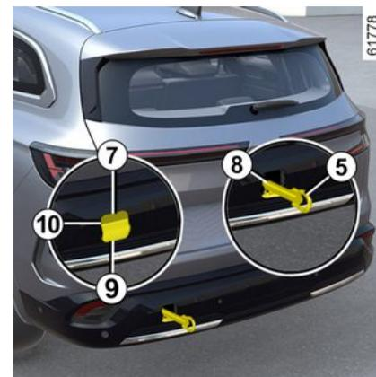
Drücken und halten Sie Zone 9, während Sie an Zone 7 ziehen, um die Klappe 10 zu öffnen.
