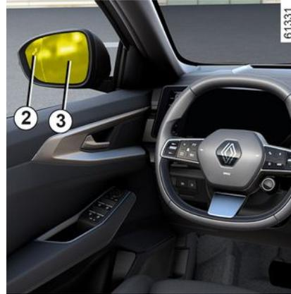
Eine Kontrollleuchte **2** befindet sich an jedem Außenspiegel **3**.
