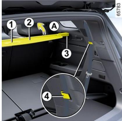
Den Sicherheitsgurt an den Haken **4** hängen, damit er nicht beschädigt wird.
