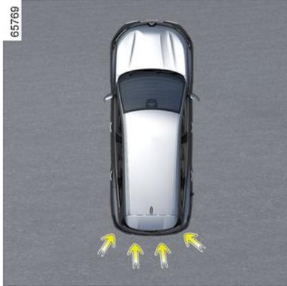
Als Ergänzung zu der Funktion „Einparkhilfe“ → 265 und anhand der Informationen der vier zentralen Sensoren, die sich am Heck des Fahrzeugs befinden, erkennt das System feste Hindernisse, die sich hinter dem Fahrzeug befinden. Wenn eine erhebliche Kollisionsgefahr besteht, veranlasst das System automatisch eine Bremsung des Fahrzeugs.
