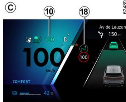
Mithilfe der Kamera, der Funktion „Verkehrszeichenerkennung“ → **218** und der mit dem Abonnement erworbenen Karte kann das System die automatische Anpassung der Fahrgeschwindigkeit **10** vorwegnehmen und verwalten, wenn sich das Fahrzeug einem Kreisverkehr oder einer Kurve nähert.
