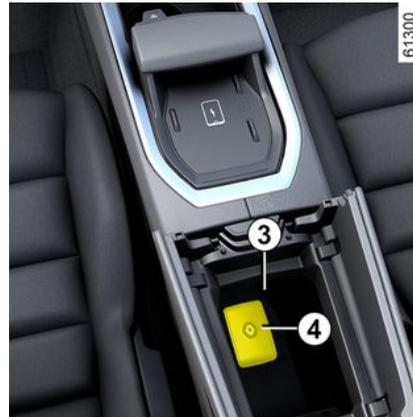
Die Meldung „Keycard im Bereich + START ablegen“ wird an der Instrumententafel angezeigt.
