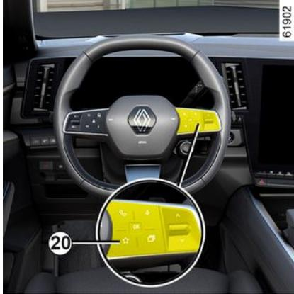
Je nach Fahrzeug durch Drücken von Bedienelement **20** am Lenkrad, können Sie folgende Funktionen entsprechend den zuvor gespeicherten Nutzungseinstellungen aktivieren:
