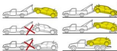
Das Fahrzeug muss entweder auf einem Tieflader transportiert oder mit angehobenen Rädern abgeschleppt werden.
