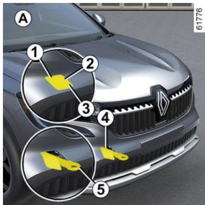
Drücken und halten Sie Zone 1, während Sie an Zone 3 ziehen, um die Klappe 2 zu öffnen.
