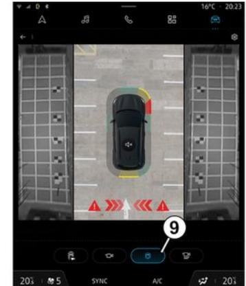
Drücken Sie auf dem Multimedia-Bildschirm die spezielle Schaltfläche **9**, um eine kombinierte Ansicht aus einer
