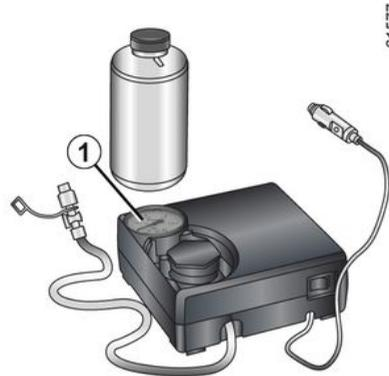
Je nach Fahrzeug können Sie bei einer Reifenpanne das Mobilitätsset verwenden, das sich unter der Bodenklappe im Gepäckraum befindet.
