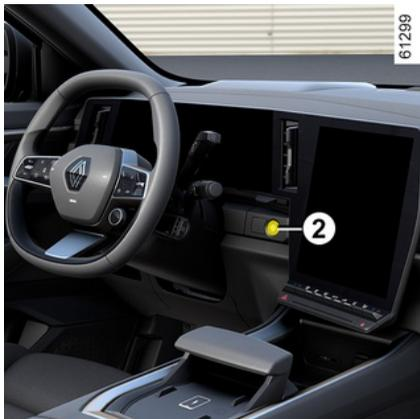
Das Fahrzeug muss stehen, Schalthebel in Stellung **P**. In der Instrumententafel erscheint die Meldung „READY“.
