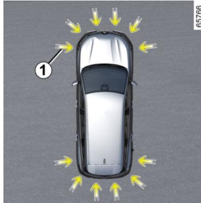
Die durch die Pfeile **11** markierten in den Stoßfängern verbauten Ultraschalldetektoren helfen bei der Suche nach Parklücken und beim Einparken. Nehmen Sie die Hände vom Lenkrad. Sie müssen nur folgende Elemente betätigen:
