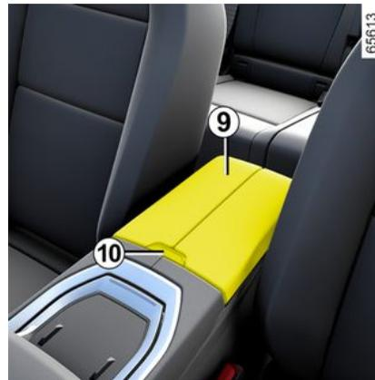
Öffnen Sie die Abdeckung 9 der mittleren Armlehne durch Drücken der Taste 10.
