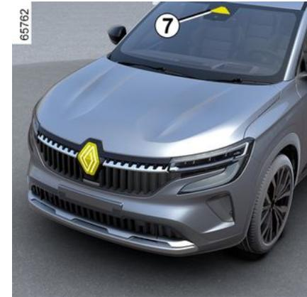
Je nach Fahrzeug ist das adaptive Fernlicht in mehrere unabhängige vertikale Segmente unterteilt. Diese Funktion nutzt die Kamera **7**, die sich hinter dem Innenspiegel befindet, um vorausfahrende und in Gegenrichtung fahrende Fahrzeuge zu erkennen.
