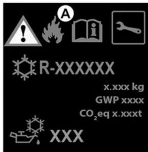
Der Kältemittelkreislauf (in dem einige Bauteile luftdicht verschlossen sind) kann fluorierte Treibhausgase enthalten.
