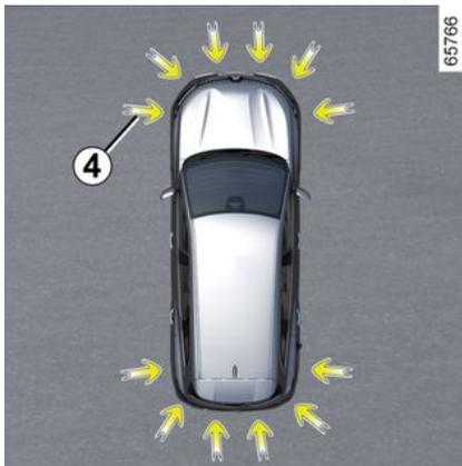
Unter Verwendung der Informationen der Kameras **1**, **2** und **3**, die sich im vorderen Stoßfänger, in den Türspiegeln und auf der Heckklappe befinden, sowie von den Ultraschallsensoren **4** an den Stoßfängern, hilft die Funktion bei schwierigen Manövern (z. B. Einparken) durch Darstellung der Fahrzeugumgebung.
