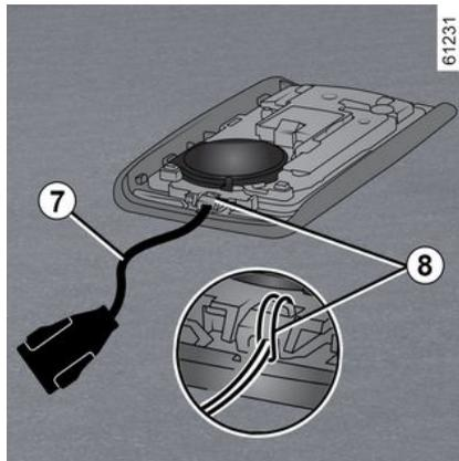
Stecken Sie die Handschlaufe in das Bauteil **8** und führen Sie das Ende der Schlaufe durch die Schnalle.
