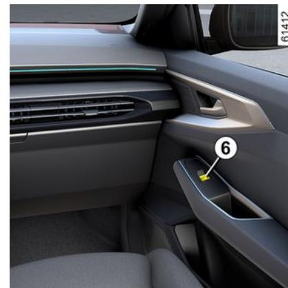
**Hinweis:** Nach dem Verriegeln der hinteren Fenster wird die Meldung „Fenster hinten verriegelt“ in der Instrumententafel angezeigt.
