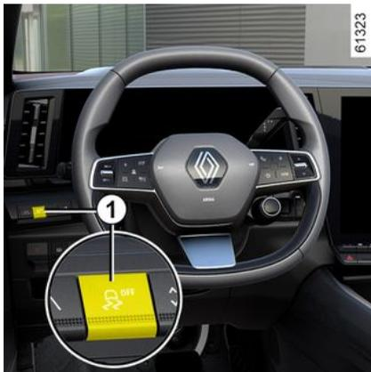
In bestimmten Situationen (beim Fahren auf sehr weichem Boden wie Schnee oder Schlamm oder beim Fahren mit Schneeketten) reduziert das System gegebenenfalls die Motorleistung, um ein Durchdrehen der Räder zu verhindern. Zum Aktivieren der
