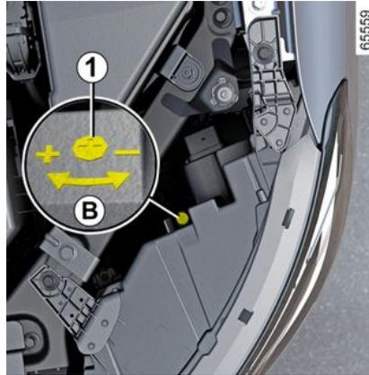
Mit einem Schraubendreher oder einem vergleichbaren Werkzeug die Schraube **1** um eine dreiviertel Umdrehung in Richtung - drehen, um die Scheinwerfer nach unten zu verstellen.
