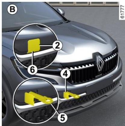
Je nach Fahrzeug kann es zum Öffnen der Klappe 6 erforderlich sein, den in der „Hands-free“-Karte eingebauten Schlüssel in die Aussparung 6 zu stecken, um diese zu ziehen → 42.
