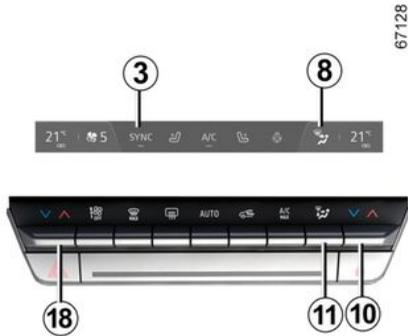
Drücken Sie **11** ein- oder mehrmals, um die Luftverteilung zu wählen. Die gewählte Luftverteilung **8** wird auf dem Multimedia-Display angezeigt. Die Stellungen sind in der folgenden Reihenfolge:
