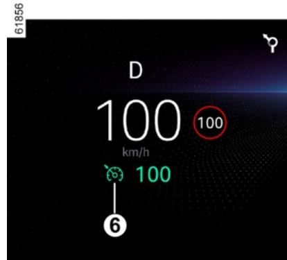
Die **6** Kontrolllampe verschwindet von der Instrumententafel, um zu bestätigen, dass die Funktion deaktiviert ist.
