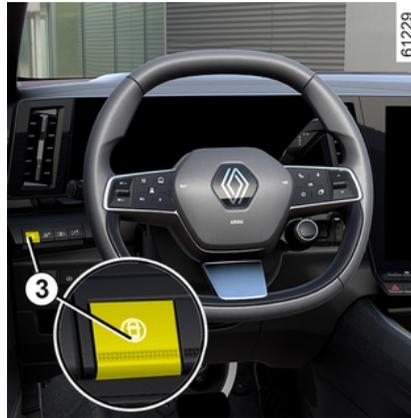
– Um die Funktion zu deaktivieren, wenn diese im Modus Benutzerdefiniert durch die Funktion „My Safety“ → 183 deaktiviert wurde, den Schalter 3 zweimal drücken. Auf den Displays und Anzeigen wird die Warnlampe
