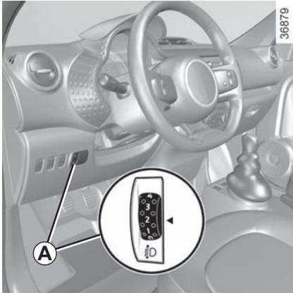
Die Leuchtweite lässt sich mit Hilfe des Reglers **A** entsprechend der Fahrzeugbeladung verstellen.
