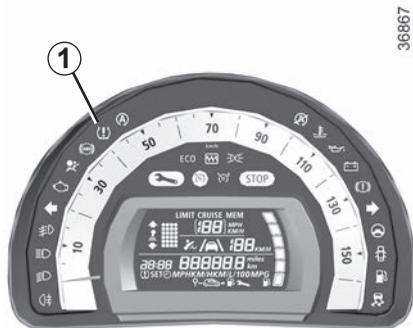
Wenn das Fahrzeug damit ausgestattet ist, gibt dieses System während der Fahrt bei Druckverlust eines oder mehrerer Reifen eine Warnung aus.
