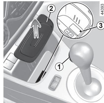
Sollte der Hebel in **P** blockiert sein, auch wenn das Bremspedal betätigt und der Entriegelungsknopf **1** gedrückt wird, kann der Hebel von Hand gelöst werden. Dazu den Bodenbelag **2** des Staufachs entfernen, um an den Freigabehebel **3** zu gelangen. Dann den Hebel **3** anheben und gleichzeitig den Entriegelungsknopf **1** am Hebel drücken.
