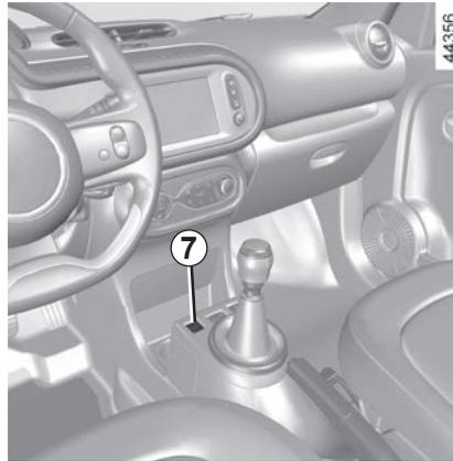
**Fahrzeuge mit ECO-Modus** (Schalter 7): Bei Aktivierung kann der ECO-Modus die Leistung der Heizung und/oder der Klimaanlage reduzieren.
