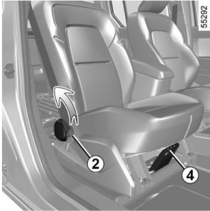
Bei manchen Fahrzeugen kann die Rückenlehne der Beifahrerseite auf das Sitzkissen geklappt werden, um mit dem Laderaumboden eine ebene Fläche zu bilden.
