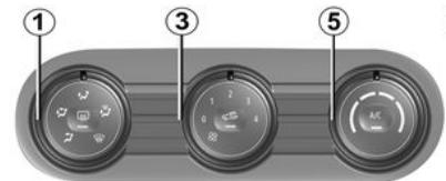
Betätigen Sie den Betätigung **3**. Je weiter das Bedienelement nach rechts gestellt wird, desto größer ist die Gebläseleistung. Wenn Sie die Luftzufuhr unterbinden wollen, stellen Sie das Bedienelement **3** auf „**0**“.
