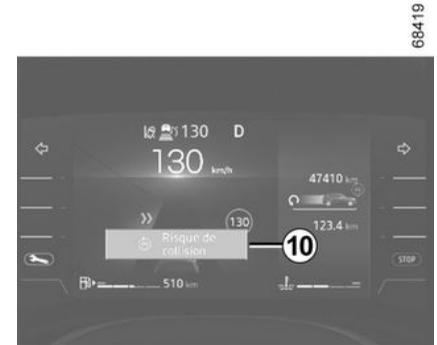
Wenn beim Fahren mit einer Geschwindigkeit zwischen ca. 70 km/h und 110 km/h die Gefahr eines Zu-
