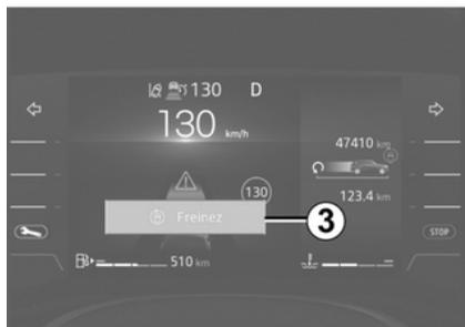
Wenn das Fahrzeug durch eine aktive Notbremsung angehalten wurde, bleibt das Fahrzeug für kurze Zeit stehen. Nach Ablauf dieser Zeit muss das Fahrzeug vom Fahrer gehalten werden, indem er den Fuß auf dem Bremspedal lässt.
