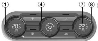
Im Funktionsmodus „Regelautomatik“ passt die Anlage die Gebläseleistung stets so an, dass das gewählte Raumklima erreicht und beibehalten wird.
