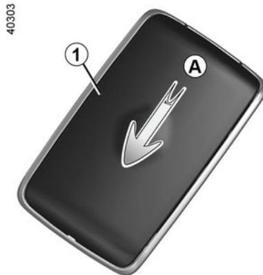
Erscheint die Meldung „Batterie Karte fast leer“ auf der Instrumententafel angezeigt, tauschen Sie die Keycard-Batterie aus:
