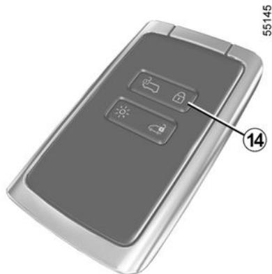
Wenn sich die Karte etwa 15 Minuten lang im Erfassungsbereich **13** befunden hat, wird die Fernverriegelung deaktiviert. Das Fahrzeug durch Drücken der Taste **14** an der Karte verriegeln.
