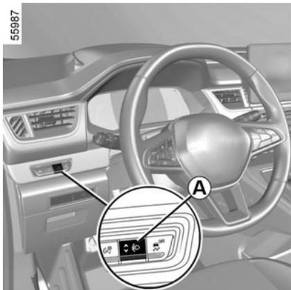
Der Regler **A** wird je nach Fahrzeugbeladung zur Leuchtweitenregulierung der Scheinwerfer verwendet.
