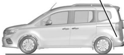
Unter Verwendung von Informationen von Radar **2** und Kamera **1** löst die Funktion bei der Gefahr einer Kollision mit einem auf der angrenzenden Fahrspur entgegenkommenden Fahrzeug eine Korrektur der Fahrzeuglenkung aus, ohne dass die Blinker aktiviert wurden.
