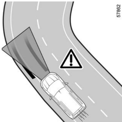
In scharfen Kurven reicht das Lenkvermögen der Funktion abhängig von der Fahrzeuggeschwindigkeit nicht aus, sodass der Fahrer unverzüglich das Steuer übernehmen muss, damit die Funktion das Fahrzeug weiterhin in der Mitte der Fahrspur halten kann.
