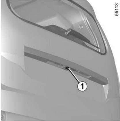
Je nach Fahrzeug überträgt, wenn der Rückwärtsgang eingelegt wird, die an der Heckklappe oder an der Flügeltür angebrachte Kamera **1** ein Bild des Bereichs hinter dem Fahrzeug an:
