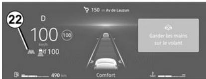
Wenn die „Spurhaltefunktion“ keine Hände am Lenkrad erkennt, wird eine mehrstufige Warnung ausgelöst:
