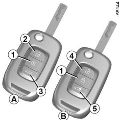
Drücken Sie auf der Fernbedienung **B** die Taste **5**, um die seitlichen Schiebetüren und die hinteren Flügeltüren zu entriegeln.
