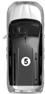
**Wenn bei laufendem Motor** eine Tür geöffnet und geschlossen wird und sich die Keycard danach nicht mehr im Bereich **5** befindet, erscheint die Meldung „Chipkarte nicht gefunden“, um darauf hinzuweisen, dass sich die Keycard nicht mehr im Fahrzeug befindet. Dadurch kann zum Beispiel ein Wegfahren nach dem Absetzen eines Fahrgasts, welcher
