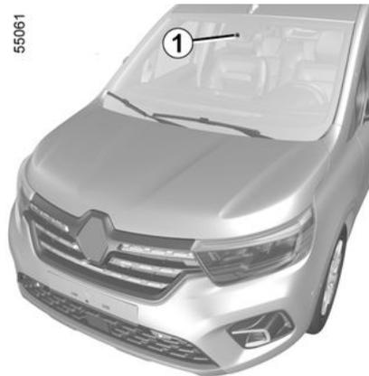
Anhand der Informationen der Kamera **1** löst die Funktion beim Überfahren einer durchgezogenen oder unterbrochenen Linie oder bei Annäherung an den Straßenrand (Spur-
