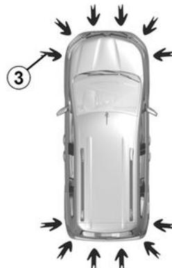
Achten Sie darauf, dass die durch die Pfeile **3** gekennzeichneten Ultraschallsensoren nicht verdeckt sind (Verschmutzungen, Schlamm, Schnee usw.).
