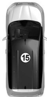
Das Fahrzeug kann nicht aus der Ferne verriegelt werden, wenn sich die Karte innerhalb der Zone befindet **15**.
