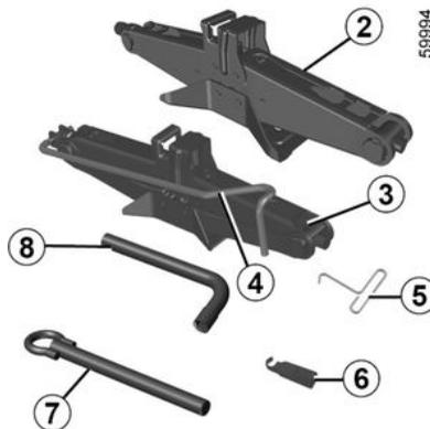
Klappen Sie den Wagenheber richtig zusammen, bevor dieser wieder in seine Aufnahme eingesetzt wird (achten Sie auf die korrekte Position der Kurbel **4**).
