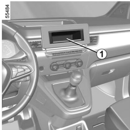
Entfernen Sie die Blende. Dahinter befinden sich die Anschlüsse (Antenne, Stromversorgung + und -, Lautsprecher).
