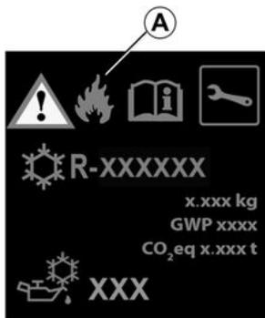
Der Kältemittelkreislauf (in dem einige Bauteile luftdicht verschlossen sind) kann fluorierte Treibhausgase enthalten.
