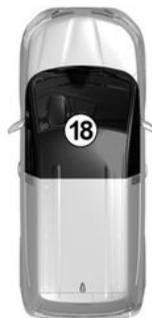
**Wenn bei laufendem Motor** eine Tür geöffnet und geschlossen wird und sich die Keycard danach nicht mehr im Bereich **18** befindet, erscheint die Meldung „Chipkarte nicht gefunden“, um darauf hinzuweisen, dass sich die Keycard nicht mehr im Fahrzeug befindet. Dadurch kann zum Beispiel ein Wegfahren nach dem Absetzen eines Fahrgasts, welcher die Keycard bei sich trägt, verhindert werden.
