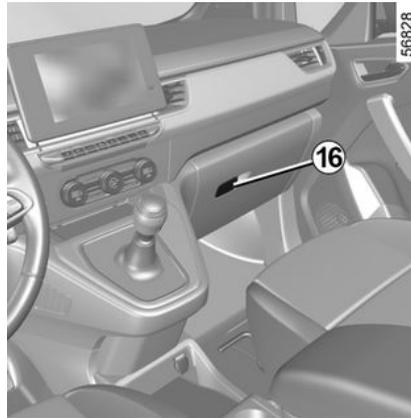
Bei damit ausgestatteten Fahrzeugen ziehen Sie zum Öffnen am Griff **16**.
