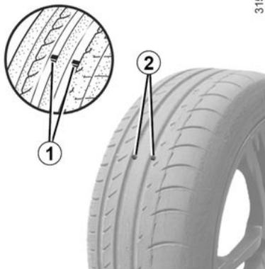
Wenn die Reifenlauffläche bis zur Abnutzungsanzeige abgefahren ist, **werden diese sichtbar 2: Dann** müssen die Reifen gewechselt werden, da das Profil **nur noch max. 1,6 mm**
